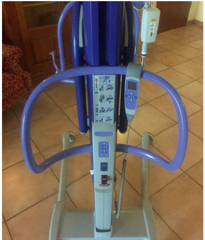
Computergesteuertes Hebeggerät, um Senioren z.B. in eine Badewanne zu heben
